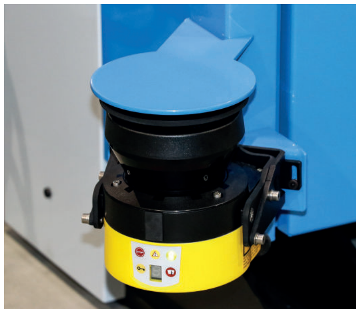
Scanner de sécurité Installé sur machines FP et KC
